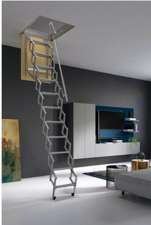
**Scala retrattile per soffitta** composta da 11 gradini e struttura mobile, realizzati in lamiera stampata 15/10 zincata e con **molle ammortizzatrici e di richiamo** che **facilitano l'apertura e la chiusura della scala.**
